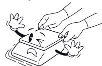
Die Waage so justieren (durch Drehen der Füße), dass die Luftblase der eingebauten Libelle zentriert ist.
